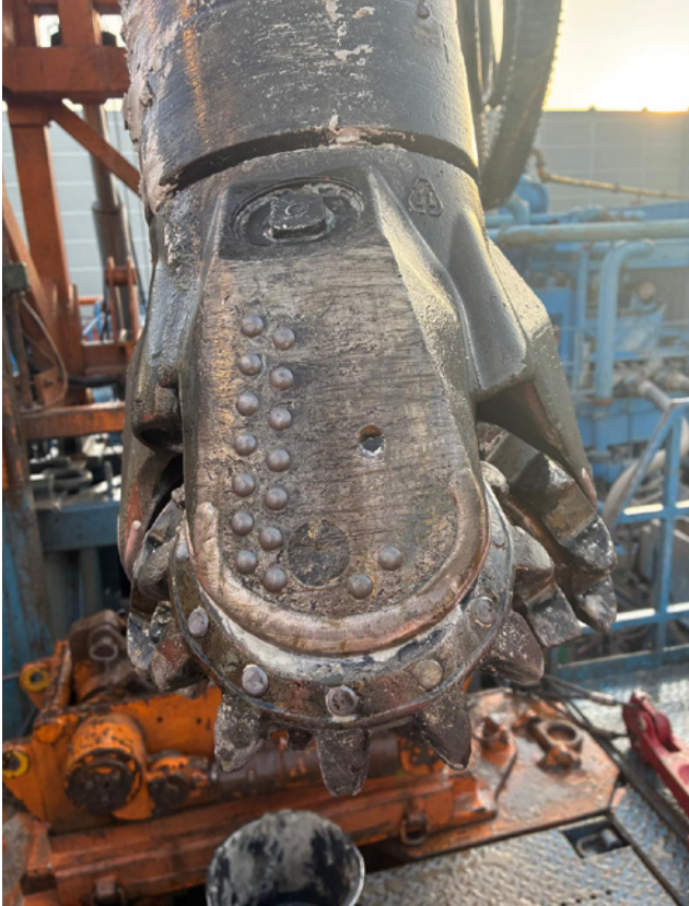
Abb. 4 Bohrkopf vor dem Einsatz in der Gt Pr 4
